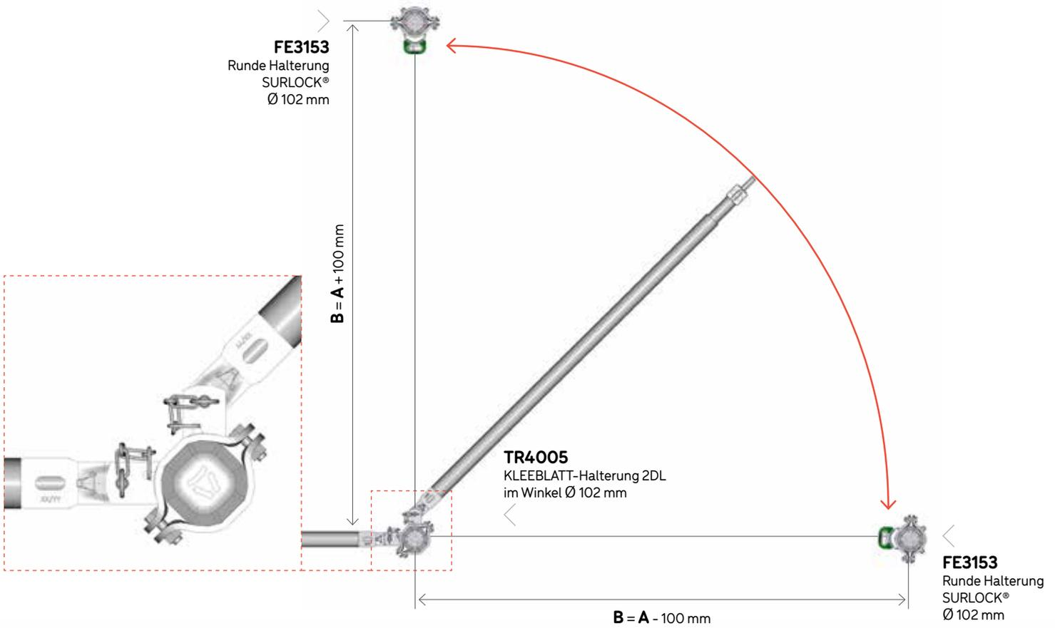
Montage an Pfosten mit 102 mm Durchmesser mit 2D-Halterungen (Ref. TR4002), SURLOCK® (Ref. FE3153) und doppeltem SURLOCK® (Ref. FE3156).
