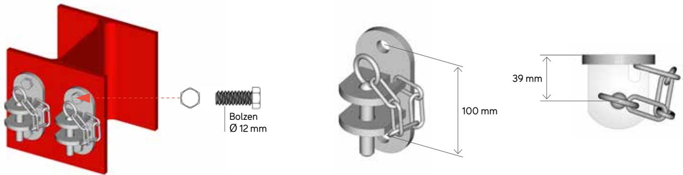
Das doppelte Anschraubteil (**Ref. FE2101**) wird an den Ansätzen der Gestellpfosten befestigt.
