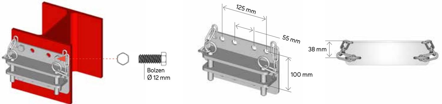
Der Multifix (**Ref. FE2017**) wird an einem kleinen I-förmigen Gestellpfosten durch Bohren der unteren Enden befestigt.
