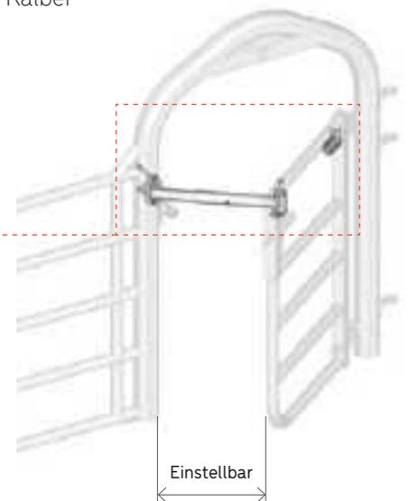
Das Einsteckteil Kälberschlupf EX 5 (**Ref. BA2098**) erlaubt nur Kälbern den Durchgang und kann auf 30 cm, 38 cm und 46 cm Breite eingestellt werden. Der erste Schlitz markiert die Position, in der der Durchlass verschlossen ist. Eine Klemmschraube auf dem Rohr hält den Schieber in Position.
