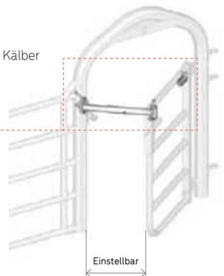
Das Einsteckteil Kälberschlupf EX 4 (**Ref. BA2097**) erlaubt nur Kälbern den Durchgang und kann auf 30 cm, 38 cm und 46 cm Breite eingestellt werden. Der erste Schlitz markiert die Position, in der der Durchlass verschlossen ist. Eine Klemmschraube auf dem Rohr hält den Schieber in Position.
