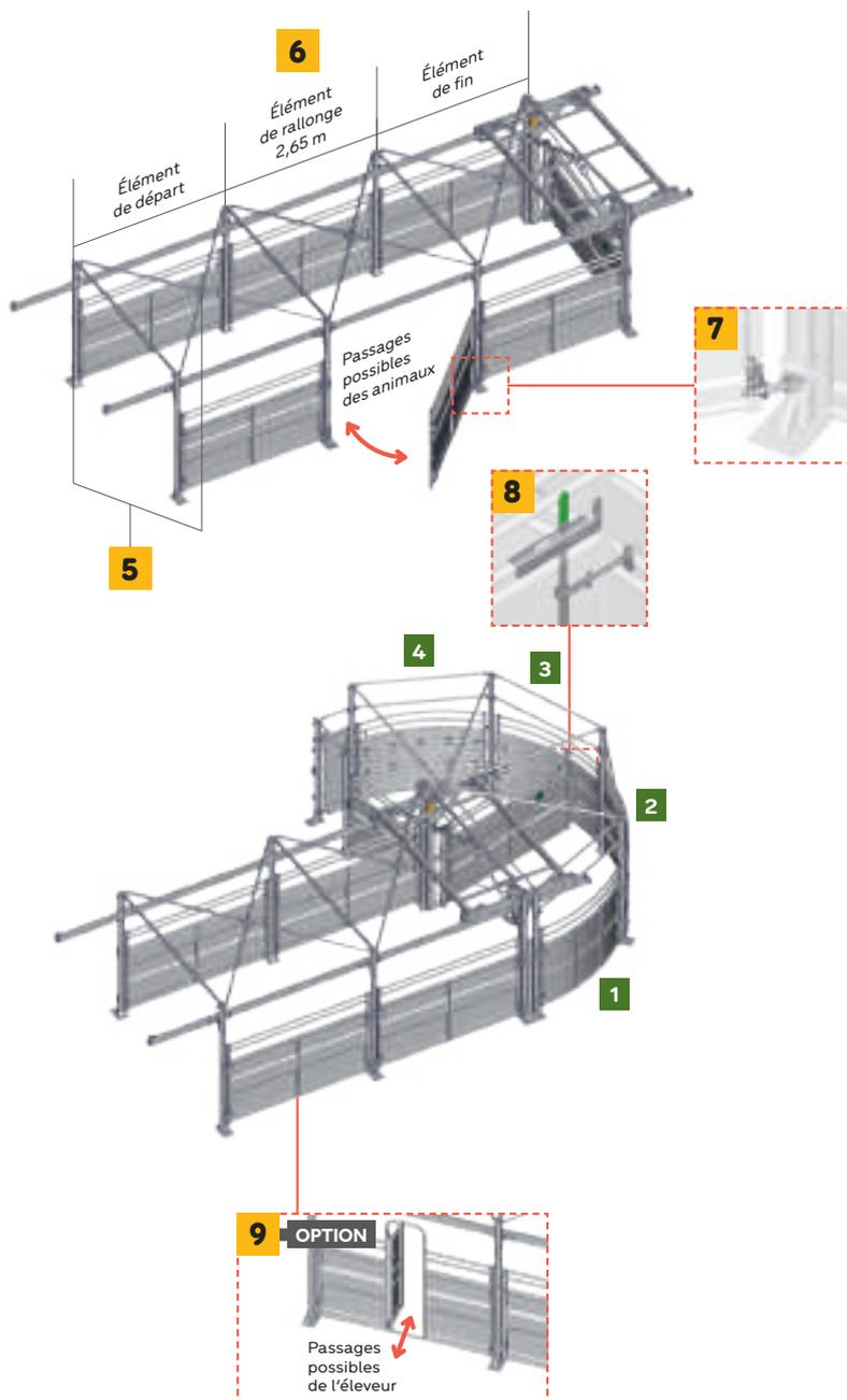
**5 OSSATURE RIGIDE AVEC CROIX D'ÉQUERRAGE ET POTEAU TRÈFLE** supportant une barrière tôle fixe.
