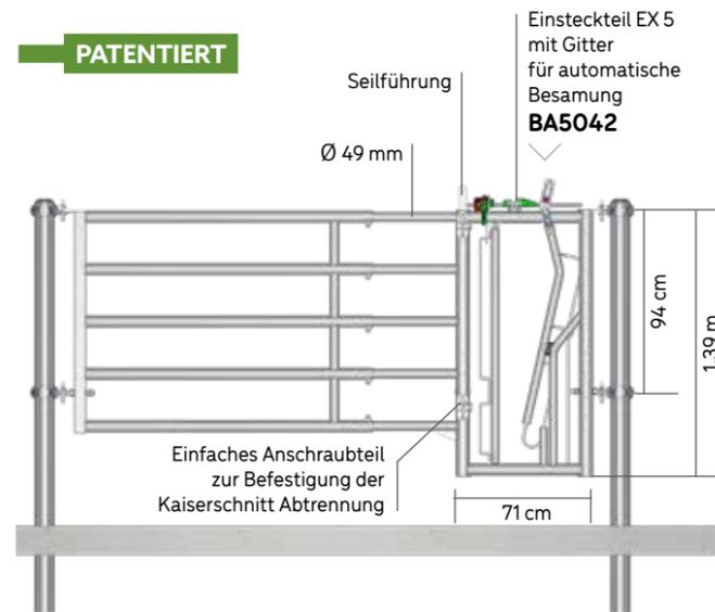
Einsteckteil EX 5 mit Gitter für automatische Besamung BA5042
