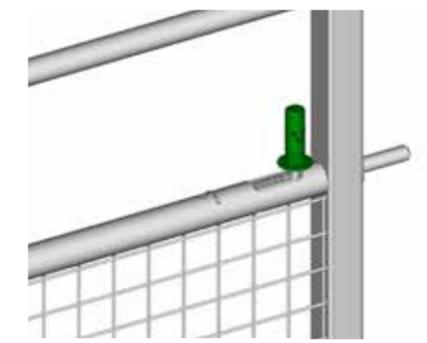
Verriegelung an der Achse Loch für Vorhängeschloss
