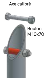
Bague inox anti-usure à l'articulation
