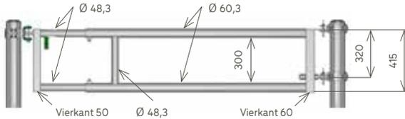
Die Vorderseite der Abtrennung ist mit einem in den Holm integrierten AUTOLOCK-Schloss ausgestattet. Der vordere Vierkant ist für die Aufnahme des Einsteckteils (SAC552) gebohrt. So kann die Abtrennung als vollständige Absperrvorrichtung montiert werden, was den Kälbern eine Möglichkeit der Selbstbedienung bietet.
